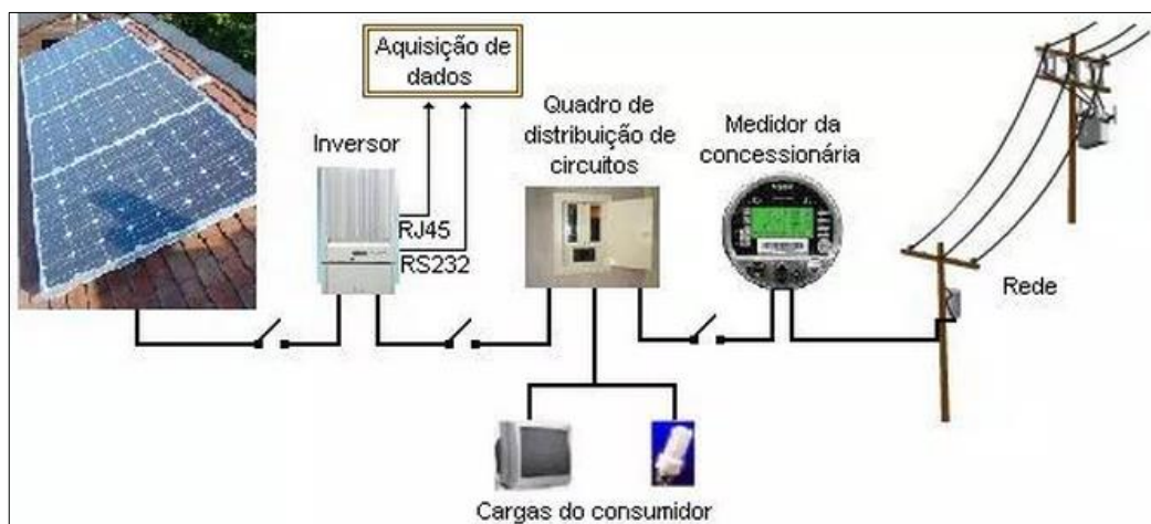
Figura 4.14 – Diagrama de um SFCR típico
